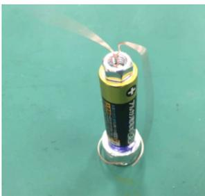
電池と磁石を組み立てて銅線がくるくる回る、簡単なモーターの工作です。
