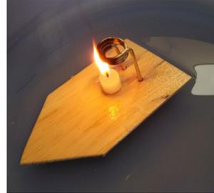
水は、水蒸気になると体積が急激に大きくなります。ポンポン船はその膨張する力を、推進力にかけて進む工作です。
